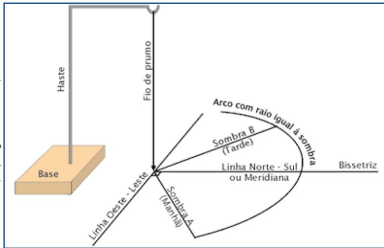
Figura 1.31. (Em perspectiva). Determinação da meridiana local usando duas sombras de mesmo comprimento de um mesmo fio de prumo. A meridiana coincide com a bissetriz destas duas sombras.
