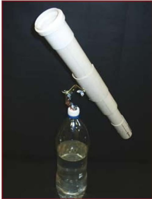
Figura 3.15. Montagem completa da luneta apoiada em seu "berço" e este preso no suporte do trilho de cortina.
