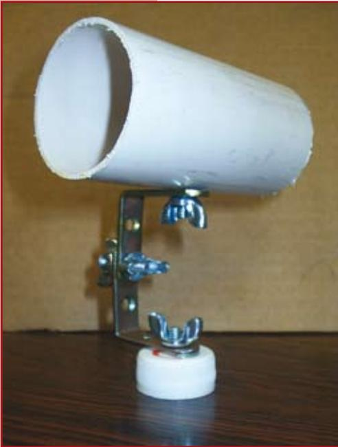
Figura 3.14. Detalhe do tripé com a tampa de garrafa PET, dois suportes de cortina pequenos e sobre eles o "berço" da luneta, pois esta será encaixada neste tubo de PVC, o qual tem um corte longitudinal na sua parte superior, não visível na foto.
