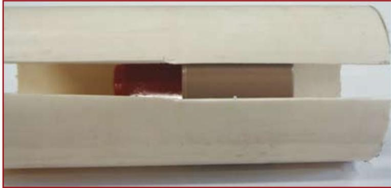
Figura 3.13. Mostra o monóculo inserido na bucha de redução e esta dentro do tubo H. Do lado esquerdo da figura pode-se ver a distância entre a ocular do monóculo e a extremidade esquerda do tubo H.
