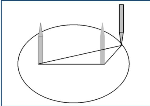
Figura 1.22. Esquema do procedimento usado para desenhar a elipse.
