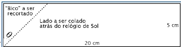
Figura 1.29B. Indicação do “bico”, com ângulo  $\theta$  igual ao da latitude local a ser recortado.
